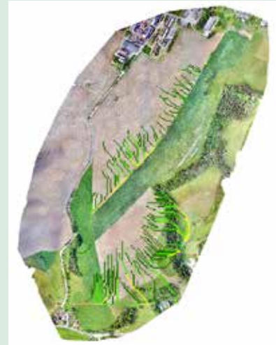
Abbildung 6: Akkumulation der Sedimentfracht in den Abflussbahnen in t/Rinne Szenario (3) Mais in Mulchsaat und Erosionsschutzstreifen (ESS)
