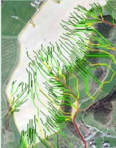
Abbildung 4: Akkumulation der Sedimentfracht in den Abflussbahnen in t/Rinne Szenario (2) Mais in Mulchsaat ohne Erosionsschutzstreifen (ESS)
