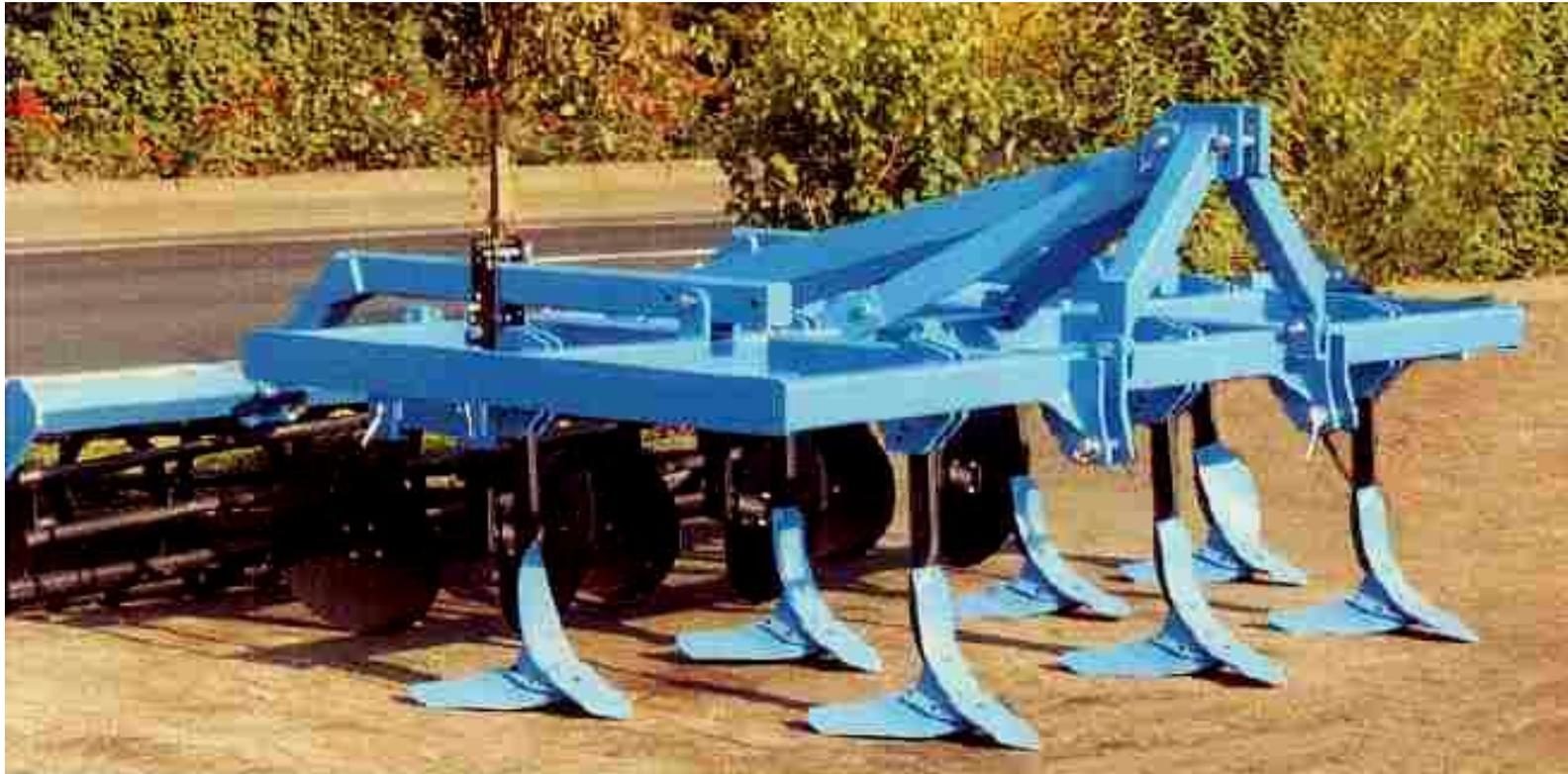
**Abb. 9: Flügelschargrubber nur zur mitteltiefen (12 bis 15 cm Tiefe) ganzflächigen unterscheiden bei der Stoppelbearbeitung**
