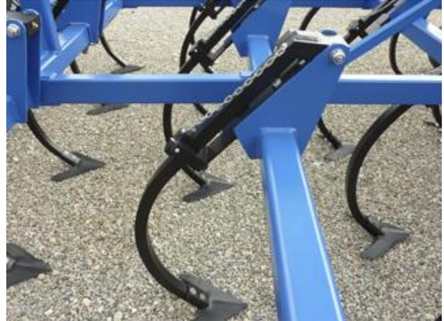
**Abb. 5: Grubber mit Gänsefußscharen zum flachen (3 bis 5 cm Tiefe) ganzflächigen unterscheiden bei der Stoppelbearbeitung**
