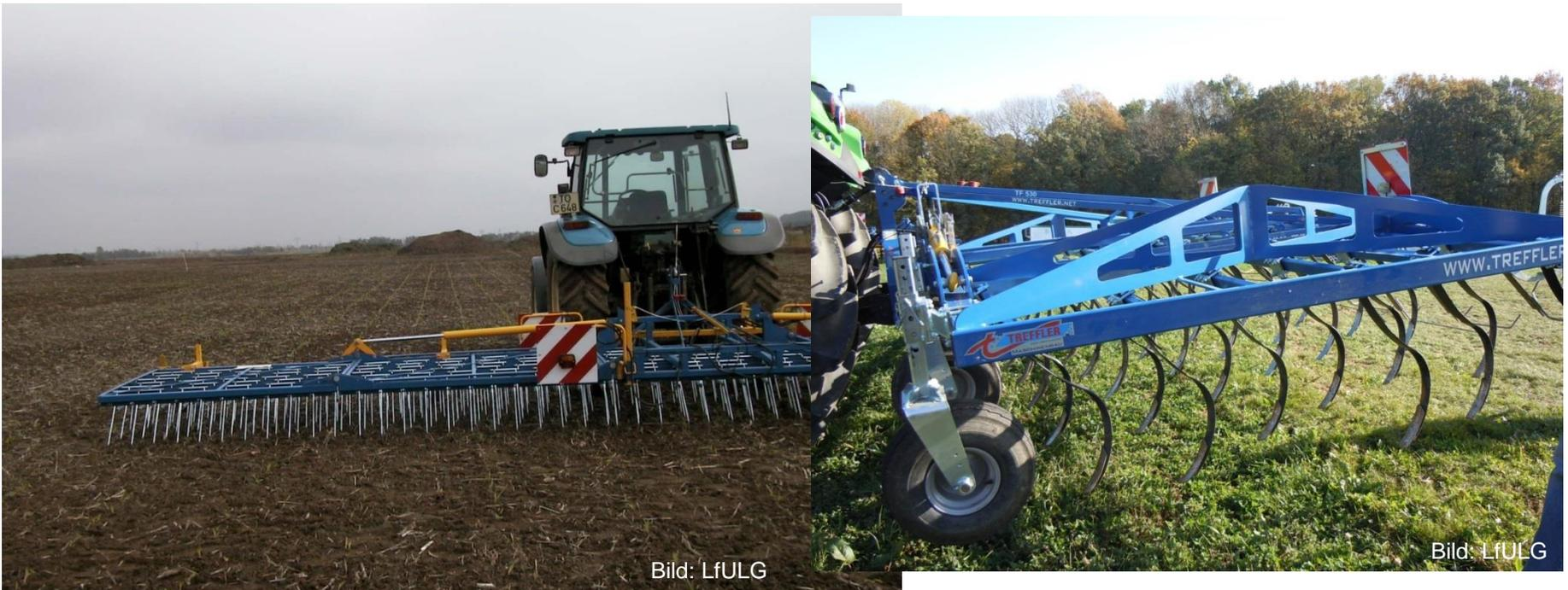
...durch mechanische Unkrautbekämpfung im Bestand mit Striegel, Hackgeräten usw. (RTK-/sensor-/kameragesteuert!)
