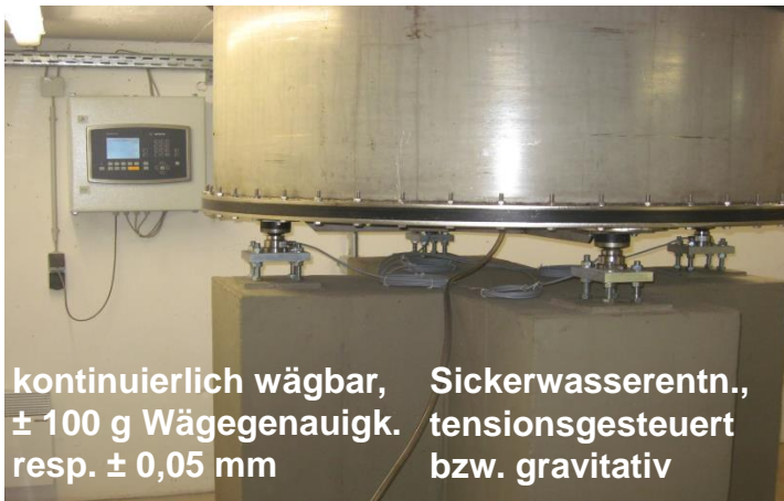
A = 2\text{m}^2 , t = 2,0 bzw. 2,5 m, monolithisch befüllt inmitten eines Feldschlages installiert
